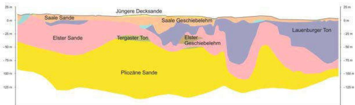
Abbildung 65: Halbschematischer geologischer West–Ost Profilschnitt (Niedersachsen Wasser 2020)
