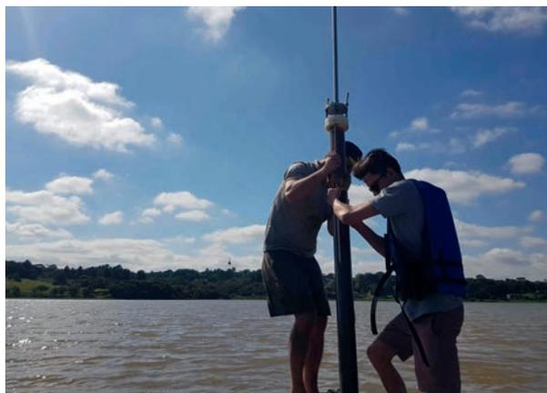
Zwei Doktoranden des KIT entnehmen einen Bohrkern zur Sedimentanalyse
