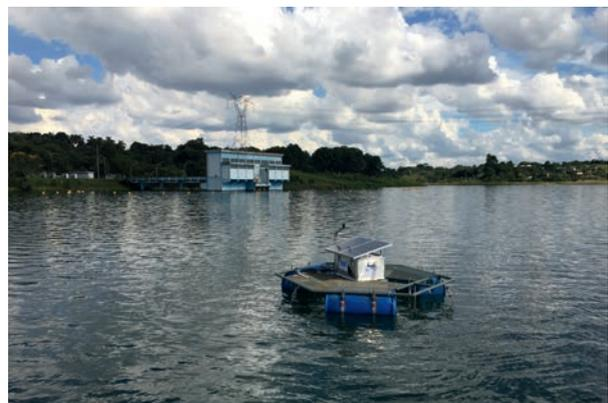
Messplattform ausgerüstet mit Wasserqualitätssensoren im Vordergrund, Wasserentnahme im Passaúna-Stausee im Hintergrund
