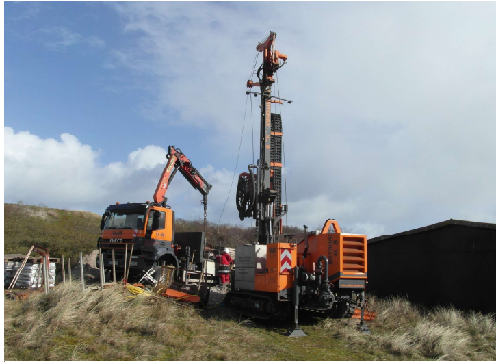
Thomas Grelle führt gerade eine Bohrlochmessung durch, mit der man Ton und Schluffschichten lokalisieren kann.
