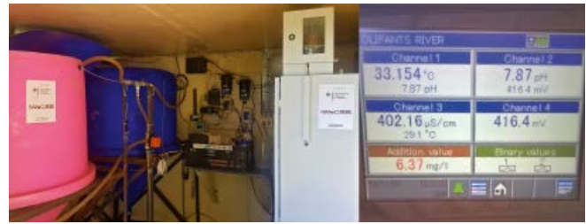
Abb. 5: iWaGSS Monitoringstation für Wasserqualität mit Sedimentsammler, Toxizitätsmonitoring, Sonden für pH, Leitfähigkeit und weitere Parameter. Fotos: Thabo David Mohlala.
