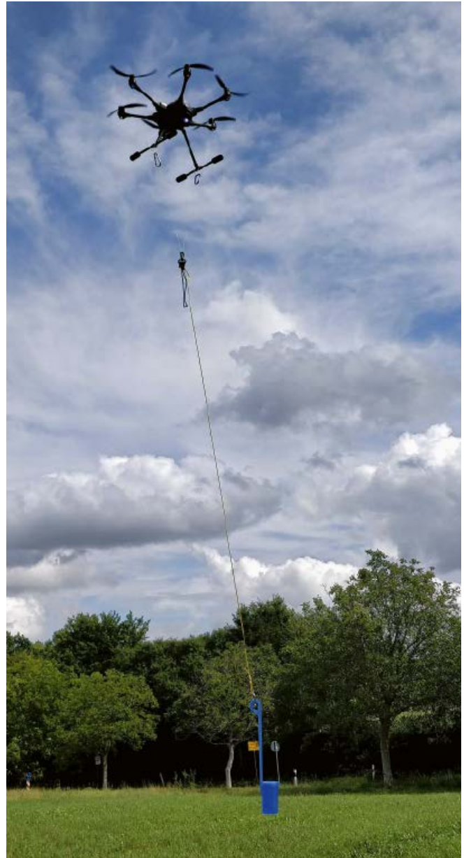
Abb. 8: Probenehmer an der Drohne
